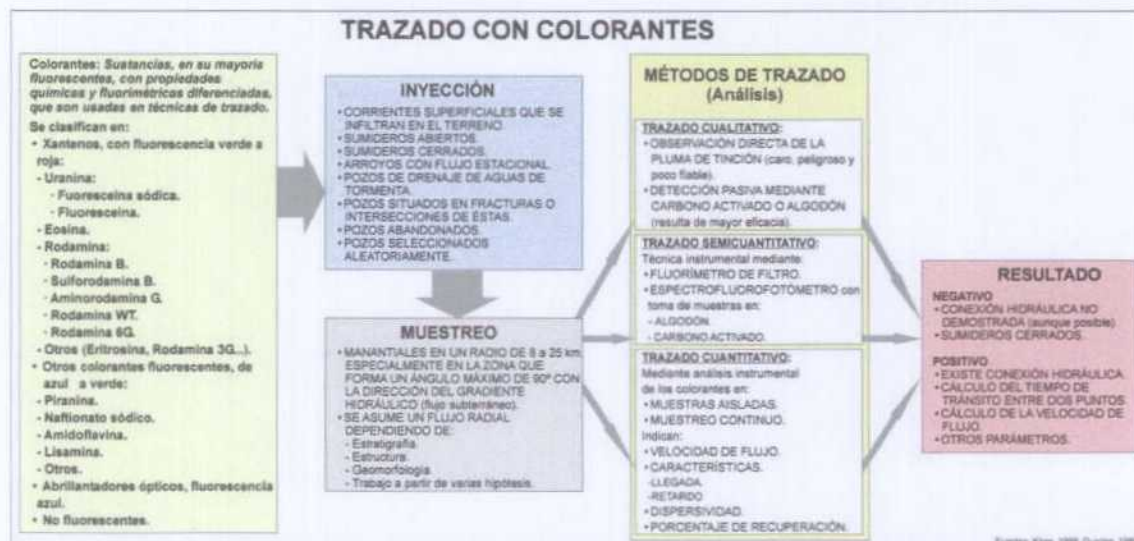
Figura 2-20: Realización de ensayos de trazado mediante inyección de colorantes.
