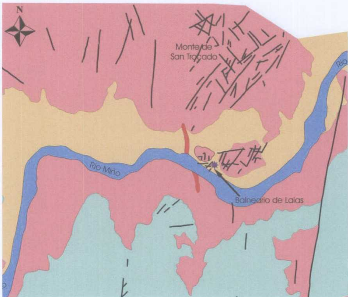
Figura 3-5: Análisis de la fracturación en el entorno del Balneario de Laias
